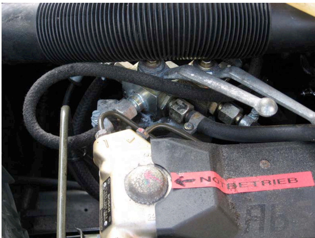
Abb. 29: Von Hand bedienbare Quetschhahnventile zur Umschaltung auf Dieselpetrieb
